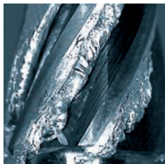
Pilnik niepowlekanany - widoczny narost
